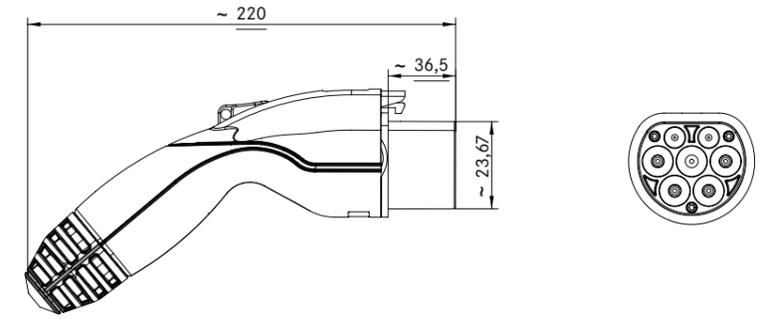
Der LAPP CHARGE Fahrzeugstecker Typ GB ist eine Steckvorrichtung für das Laden von Elektrofahrzeugen, welche die Verbindung zwischen der Ladeleitungsgarnitur und der Fahrzeugdose der Fahrzeugs herstellt.
