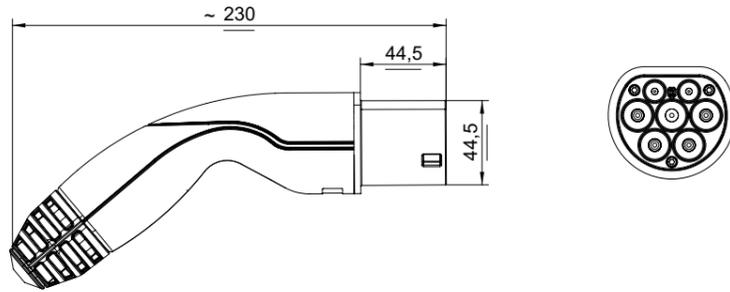
Der LAPP CHARGE Ladestecker Typ 2 ist eine Steckvorrichtung für das Laden von Elektrofahrzeugen, welche die Verbindung zwischen der Ladeleitungsgarnitur und der Ladedose der Infrastruktur herstellt. Die dreiteilige Schalenbauweise ermöglicht unterschiedliche Farbvarianten, die bei individuellen Farbwünschen berücksichtigt werden können. Standardfarben: orange/schwarz.
