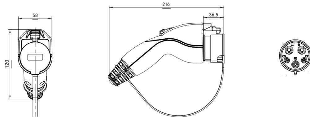
Die LAPP CHARGE Ladekupplung Typ 1 nach IEC 62196 und SAE J1772 ist eine Steckvorrichtung für das Laden von Elektrofahrzeugen, welche die Verbindung zwischen dem Ladestecker des Elektrofahrzeugs und der Ladeleitungsgarnitur herstellt.
