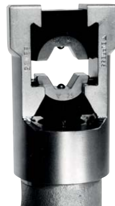
Cu 10 - 400 mm 2 C-avgr. 10 - 120 mm 2 Fe-Al 62 - 99 mm 2
