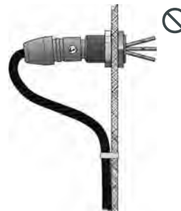
Entlastungsschleife – falsch Incorrect stress loop
