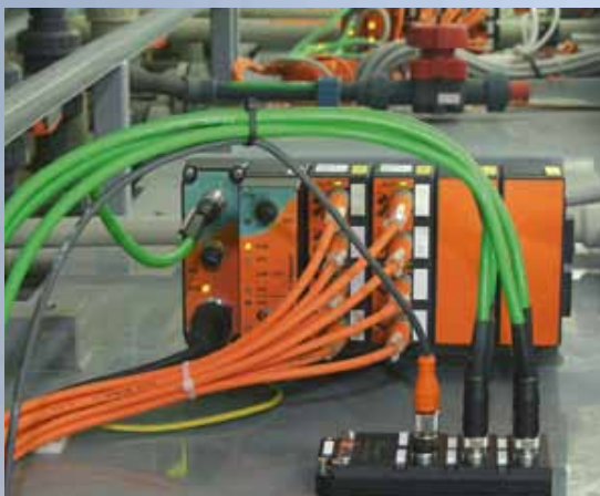
En dubbelskärmad kopparkabel, med både aluminiumfolie och kopparfläta, erbjuder ett mycket gott skydd mot elektromagnetiska störningar (EMI).
