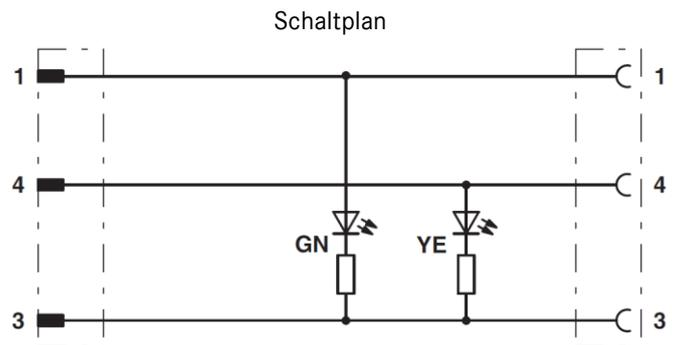
Kontaktbelegung der M12-Stecker/M8-Buchse
