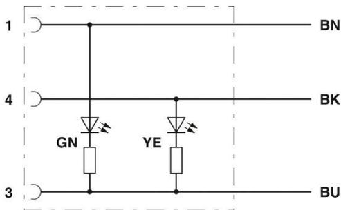
Kontaktbelegung des M8-Buchse, mit LEDs
