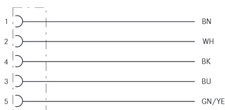
Kontaktbelegung der M12-Buchse
