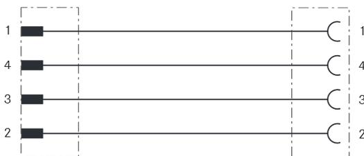
Kontaktbelegung des M8-Stecker und der M8-Buchse
