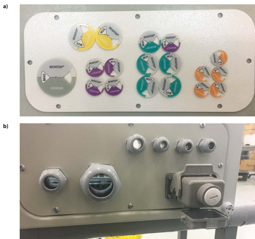
Rys. 1. Narzędzie Skintop Locator: a – znaczniki zainstalowane na płycie dolnej obudowy z rozplanowanymi wymiarami, b – zamontowane dławnice firmy Lapp Kabel – gotowe do zainstalowania przewodów
