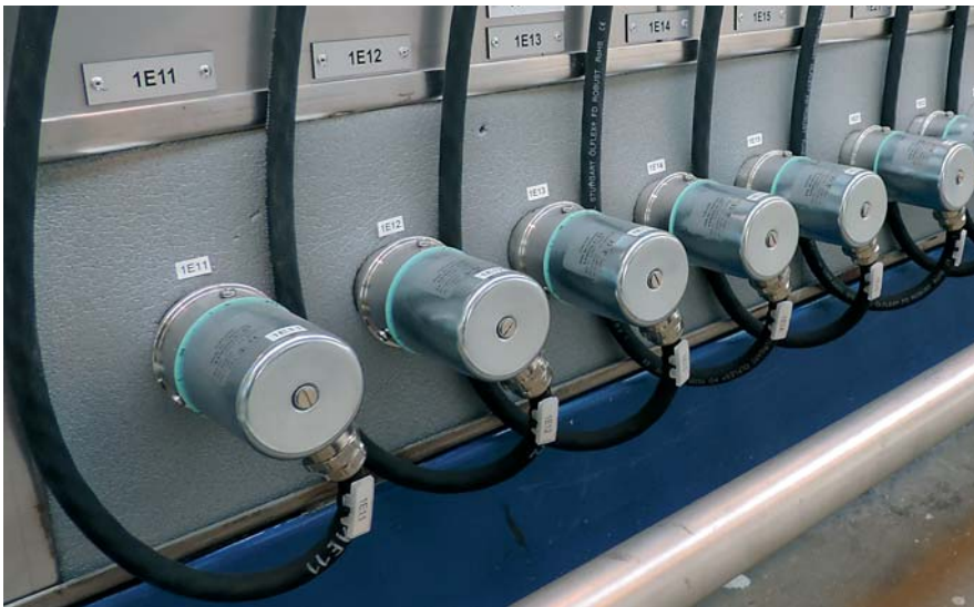
Rys. 4. Przewody Olflex Robust po podłączeniu grzałek
