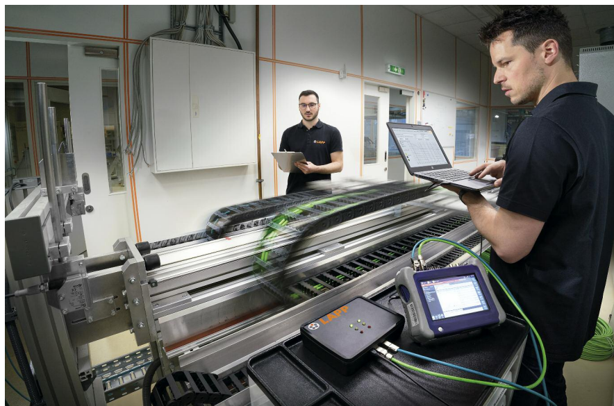
Rys. 1. Moduł Lapp „Predictive Maintenance Box”, który wykorzystuje wskaźnik predykcyjny Lapp (LPI) do pomiaru pozostałego okresu użytkowania przewodu transmisji danych
