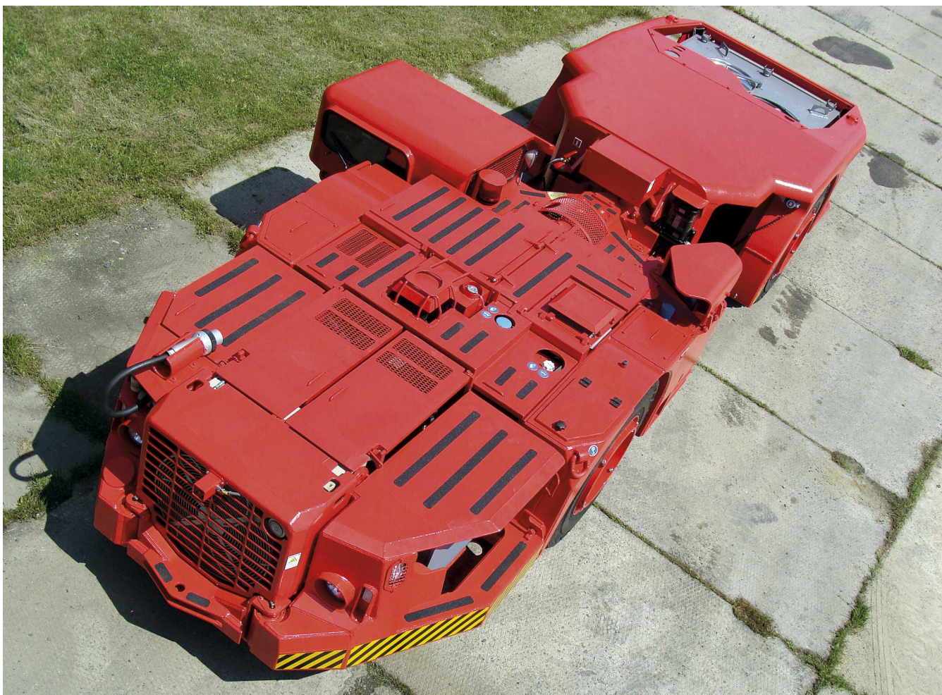
Rys. 1. Samojezdny wóz strzelniczy typ RTB15 produkowany przez BH Ruda
