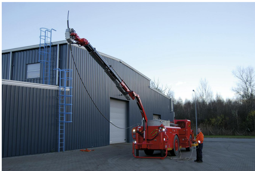
Rys. 2. Samojezdny wóz strzelniczy RTCh23 z wysięgnikiem roboczym służącym do ładowania materiałów wybuchowych w wachlarzu otworów strzałowych
