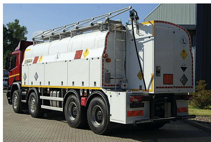
Rys. 3. Pojazd MEMU wytwarzający materiały wybuchowe
