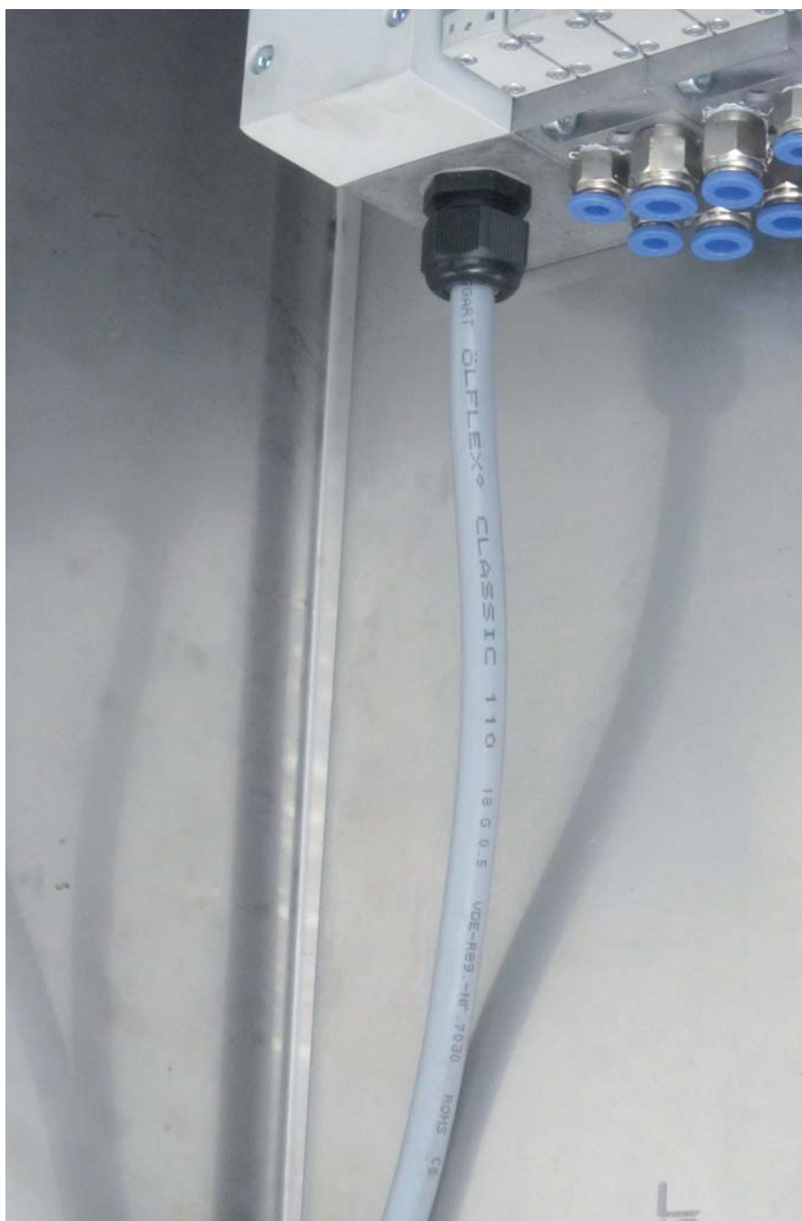
Rys. 4. Instalacja wykonana za pomocą przewodu Ölflex Classic 110
