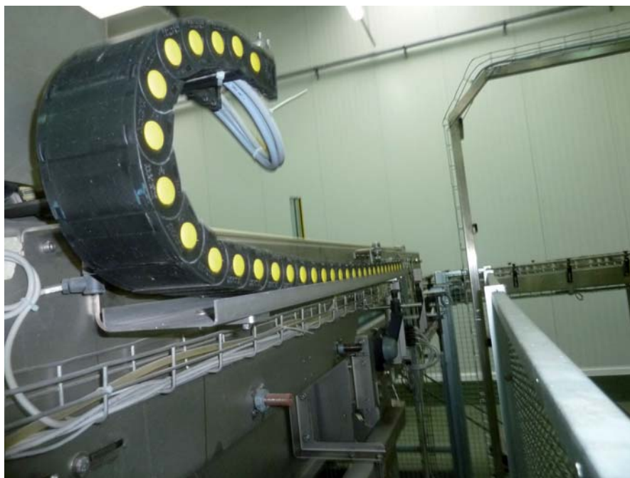
Rys. 4. Prowadnica łańcuchowa marki Brevetti Stendalto na linii technologicznej SM w Gostyniu
