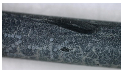
Uszkodzenia powstałe podczas obciążeń DC. Z testowanych 238 próbek uszkodzeniu uległo 44%
