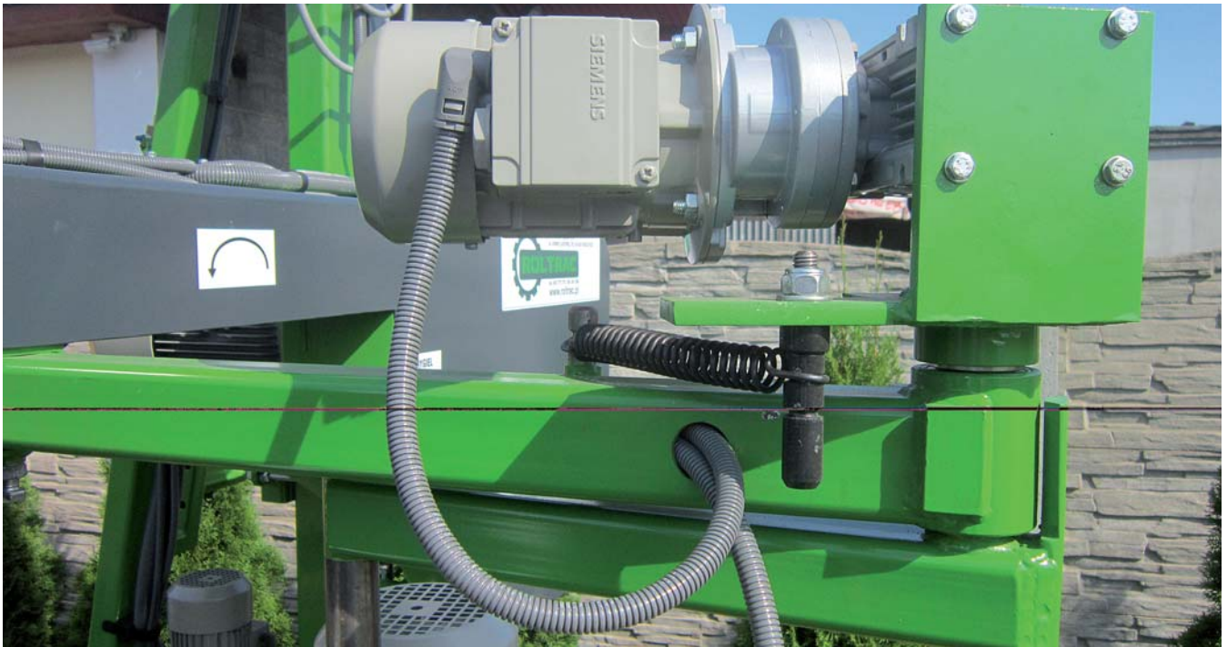
Rys. 2. Zastosowany w urządzeniu wąż ochronny Silvyn Rill PA6
