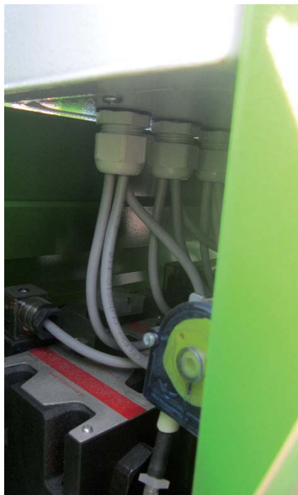
Rys. 6. Połączenia elementów wykonawczych rozprowadzone za pomocą przewodu Olflex Classic 110 w wersji 5g6
