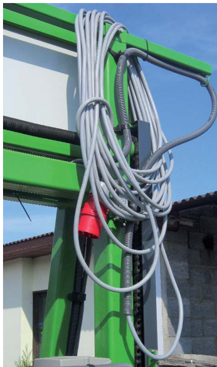
Rys. 5. Przewód zasilający Olflex Classic 110 w wersji 5g6
