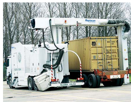
Rys. 4. Skaner RTG portalowy, do skanowania dużych pojazdów
