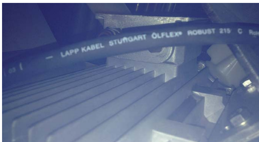
Rys. 3. Przewód Ölflex Robust 215C w maszynie firmy ALS
