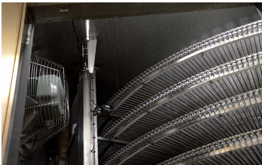
Rys. 2. Spiralna mroźnia liniowa – we wnętrzu temperatura spada nawet do -40^{\circ}\text{C}
