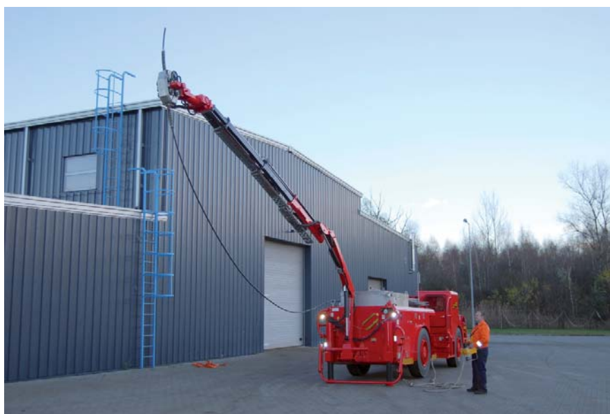
Rys. 6. Samojezdny wóz strzałowy RTCh23 z wysięgnikiem roboczym służącym do ładowania materiałów wybuchowych w wachtlarzu otworów strzałowych
