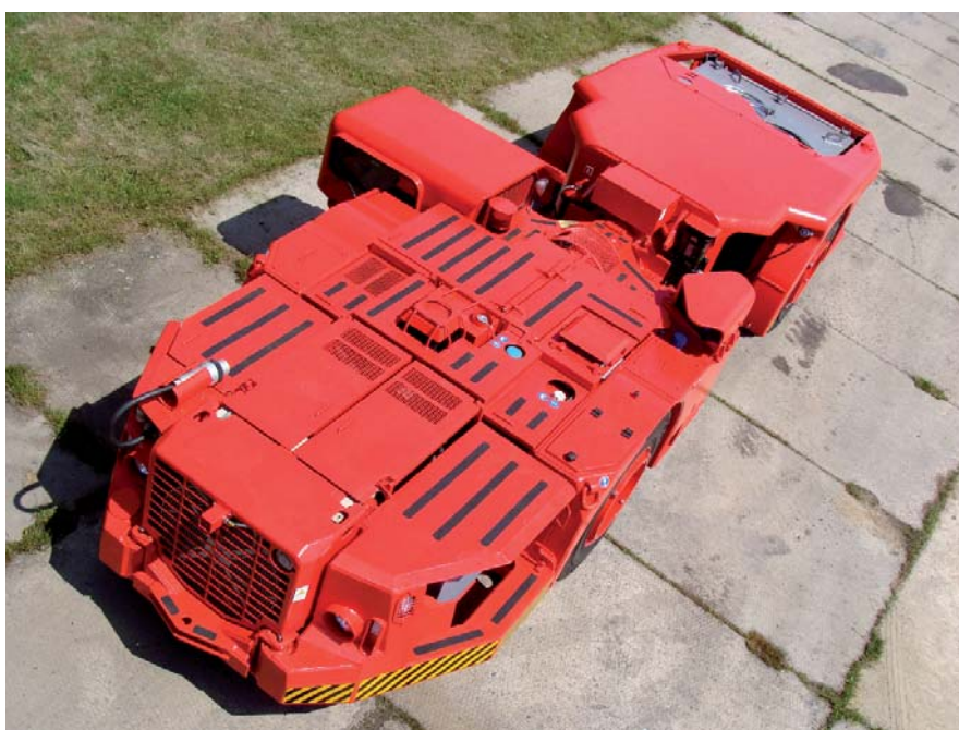
Rys. 1. Samojezdny wóz strzałowy RTB15 produkowany przez BH Ruda
