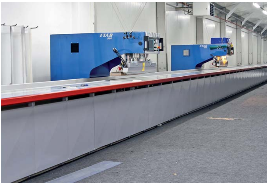
Rys. 2. Zgrzewarka Fiab 900 w wersji jezdnej
