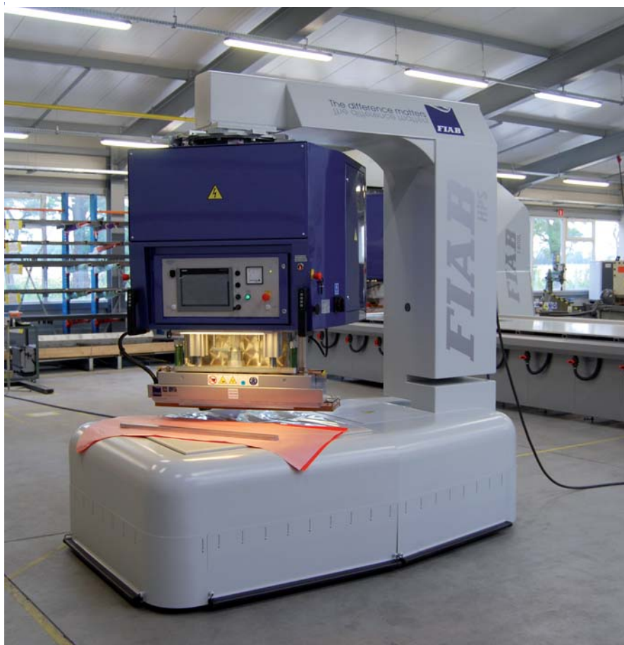
Rys. 7. Samojezdna zgrzewarka Fiab HPS
