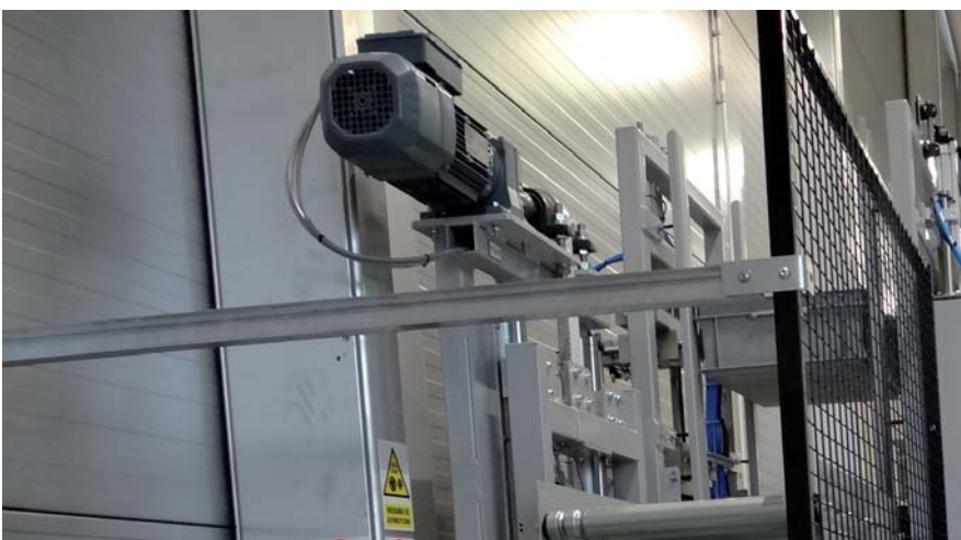
Rys. 2. Zasilanie i sterowanie napędu przewodami Ölflex
