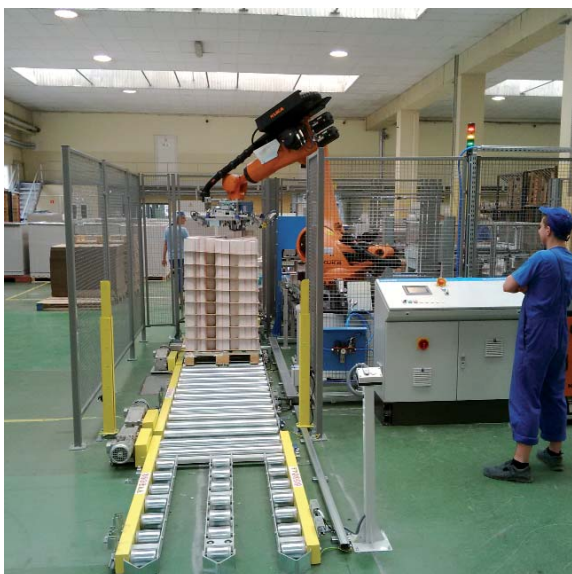
Rys. 8. Procesy segregacji i paletyzacji są oparte na pięcioosiowych robotach paletyzujących
