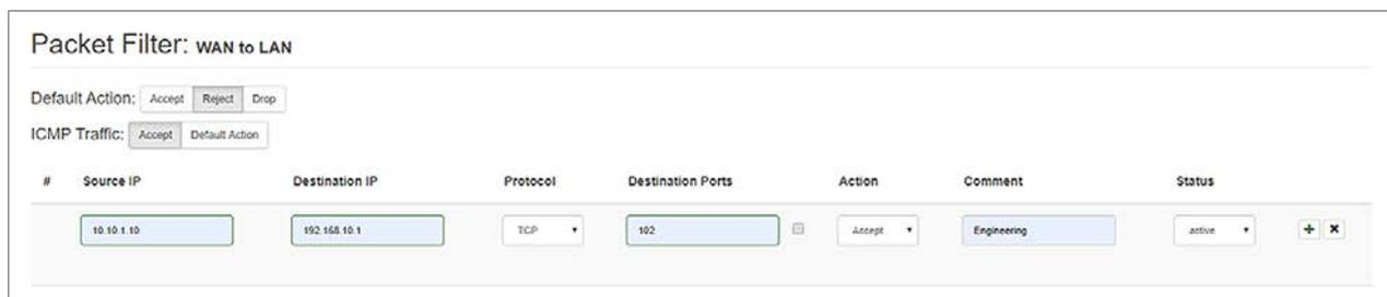
**Source IP** gibt die IP-Adresse des aktiven Gerätes im Produktionsnetzwerk (WAN) an. **Destination IP** das angesprochene Gerät im Maschinennetzwerk (LAN).
