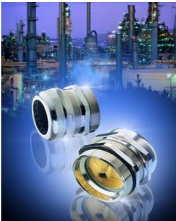
De acordo com a Lapp, a montagem do Skintop® MS-SC-M Brush não poderia ser simples e pode ser concluída em uma única operação. Para instalação, basta inserir o cabo, fixar na mola de contato, deslizar a blindagem sobre a escova, depois de fechado, o cabo é automaticamente centralizado, fixado, livre de tensão e hermeticamente selado até a classe de proteção IP 68.
