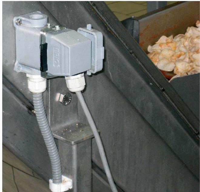
4. Conector EPIC® instalado num fritador de chips
