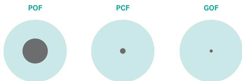
Beim Vergleich der unterschiedlichen Steckerbohrungen bzgl. Faserdurchmesser wird ersichtlich, dass diese untereinander nicht austauschbar sind. In anderen Worten: Ein PCF-Stecker kann nicht für eine POF-Leitung verwendet werden. Ein PCF-Stecker kann nicht für eine POF-Leitung verwendet werden, da die Fasergeometrien und Parameter nicht zueinander kompatibel sind.
