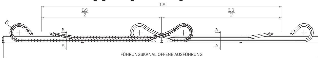
Die Seitenwände des Führungskanals werden in einem Montagesatz geliefert, bestehend aus Seitenwänden mit einer Standardlänge von 2000 mm, Verbindungswinkeln und Befestigungsschrauben.
