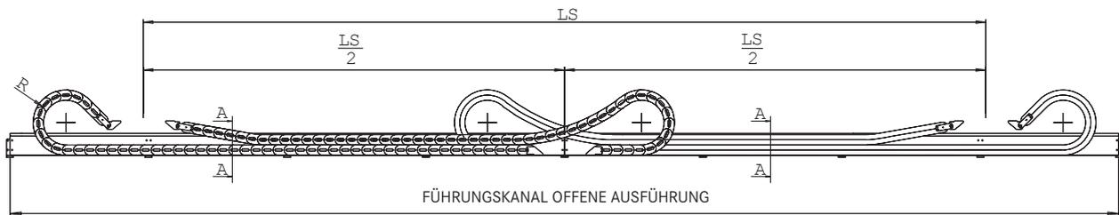
Die Seitenwände des Führungskanals werden in einem Montagesatz geliefert, bestehend aus Seitenwänden mit einer Standardlänge von 2000 mm, Verbindungswinkeln und Befestigungsschrauben besteht.
