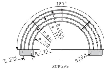
Um einen einwandfreien Betrieb der Kette zu gewährleisten, muss die Kette in einer bestimmten Stellung verfahren. Hierfür gibt es ein Auflagegestell, das sämtliche Funktionsanforderungen erfüllt. Für individuelle Anwendungen sind auch Auflagegestelle mit Klemmplatten und Sonderabmessungen lieferbar.
