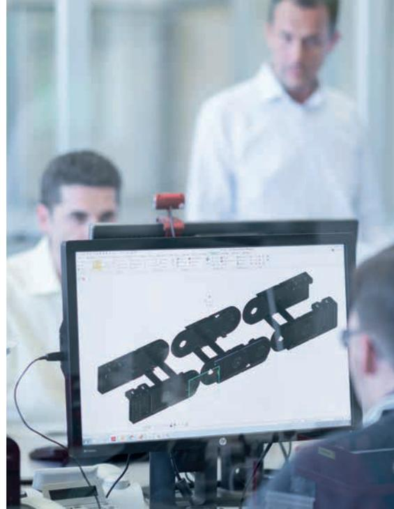
CAD-Entwurf von Schleppkettensystem
