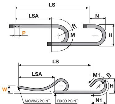
**L=LSA + M oder M1** Länge der Kette (L)= Strecke LSA plus Länge der Kurve (M) oder (M1)
