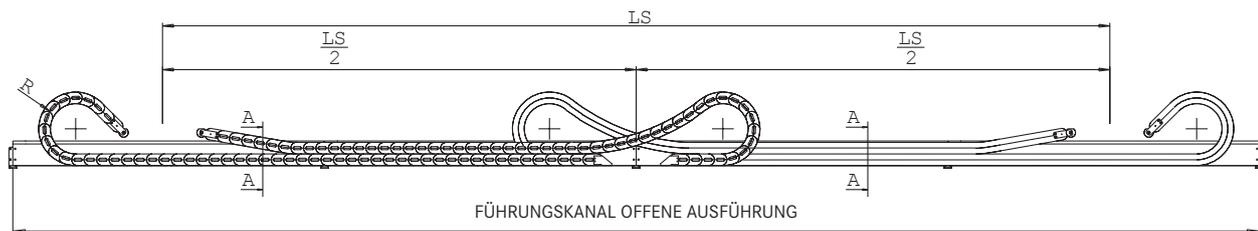
Die Seitenwände des Führungskanals werden in einem Montagesatz geliefert, bestehend aus Seitenwänden mit einer Standardlänge von 2000 mm, Verbindungswinkeln und Befestigungsschrauben besteht.
