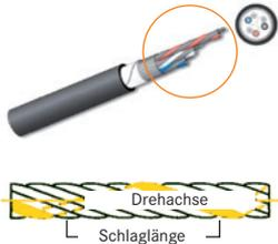
Bei der Herstellung eines mehradrigen Kabels werden die einzelnen Adern verseilt.
