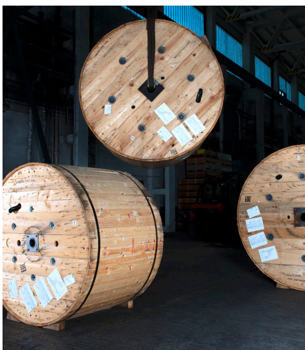
Pobité velké bubny s kolíčkou, využití mostového jeřábu pro nakládku
