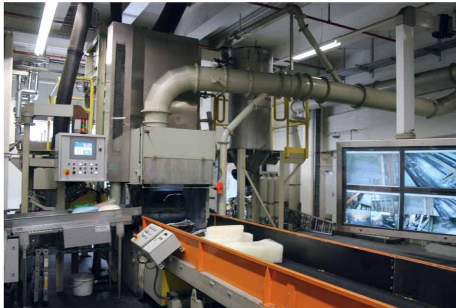
*Nivel de alimentación del mezclador interno: aquí se introducen las balas de caucho*
