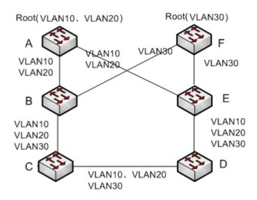
Figure 217 DRP-IEC62439-VLAN-Based
