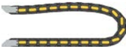
Преднагрузка кабельной цепи без «начинки»
