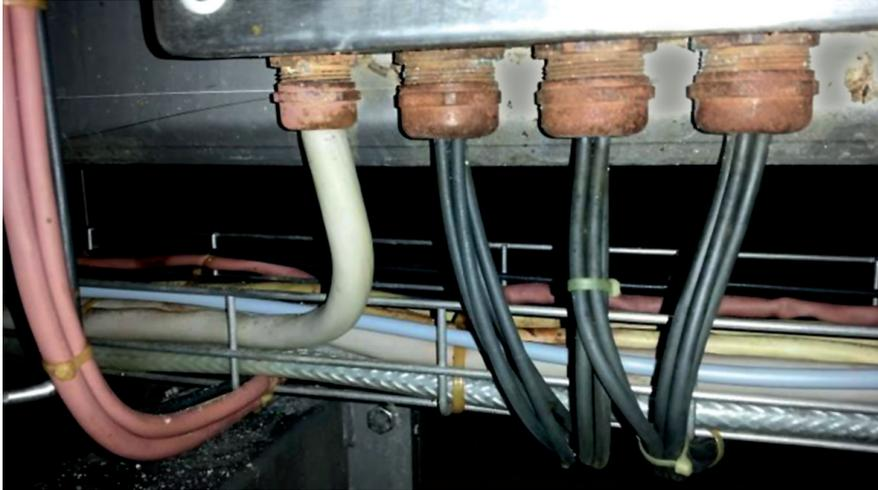
식품 산업에서 케이블 및 케이블 부품은 특히 가혹한 조건 하에 놓입니다. 부적합한 부품을 사용할 경우 그림과 같이 나사 조인트가 부식되거나 피복이 부풀 수 있습니다. 결과적으로 부품의 기능이 일부 상실되거나 위험한 상황이 발생할 수 있습니다.
