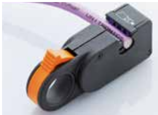
1. Desforre con la herramienta FC STRIP
