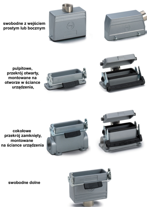
Typy obudów złączy przemysłowych
