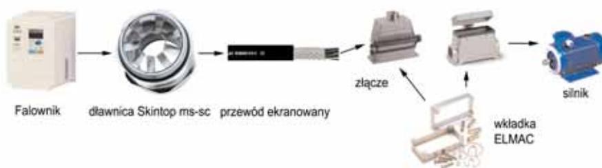
Rys. 19. Schemat prawidłowego podłączenia silnika z falownikiem
