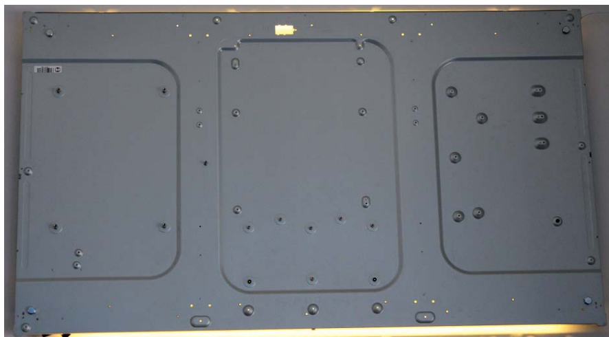
Rys. 5. Chassis – metalowa podstawa do montażu elektroniki obrabiana w stałej obecności oleju smarowego
