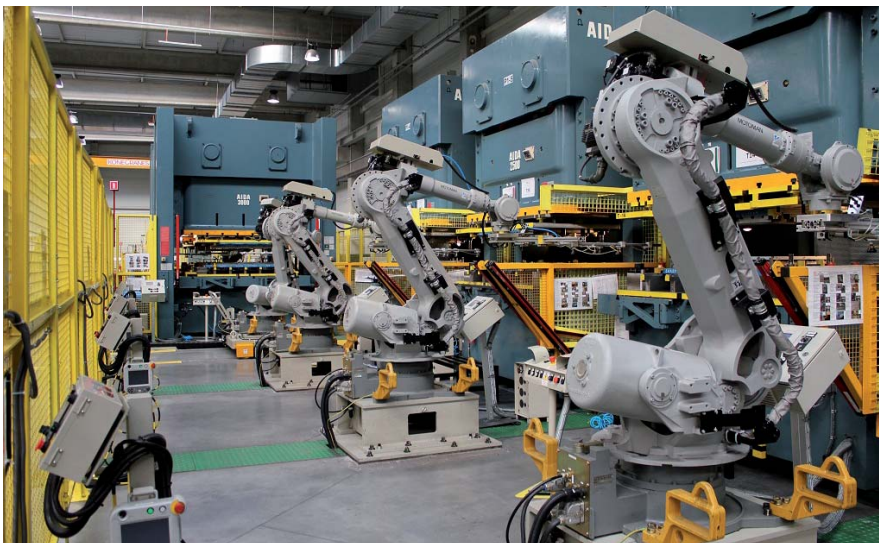
Rys. 1. Park maszynowy w firmie Sohbi Craft Poland – linia wytłaczająca metalowe elementy
