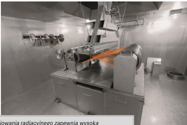
Proces sieciowania radiacyjnego zapewnia wysoką wytrzymałość przewodów.
