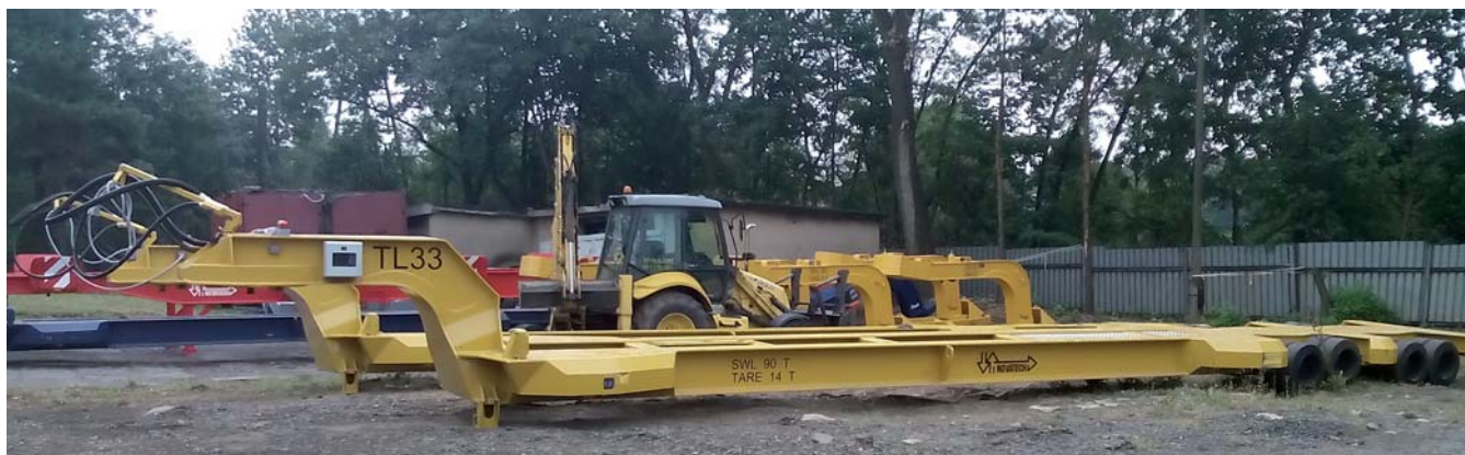
Rys. 1. Urządzenie Flexmaster do transportu i załadunku kontenerów na nabrzeżu portowym
