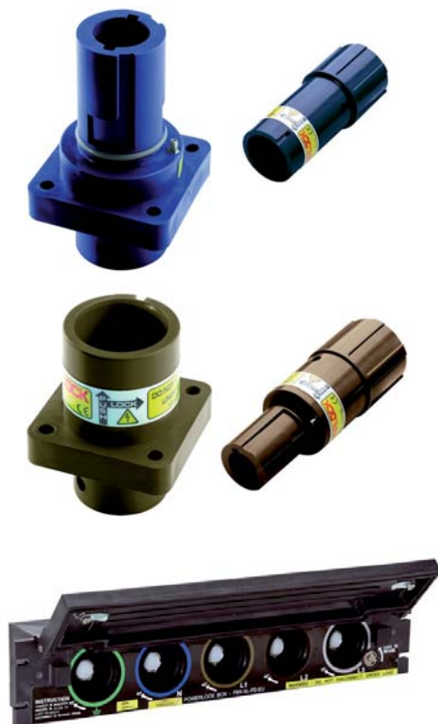
Rys. 2. Złącza Epic Powerlock A1, D6, A6, F6 (a) – dostępne w kolorystyce zharmonizowanej, każdy kolor posiada inne kodowanie aby wyeliminować pomyłki; oraz Powerlock Box (b) – zestaw złączy zapewnia prawidłową kolejność podłączenia i odłączenia (PE, N, L1, L2, L3)
