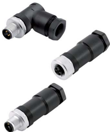
Rys. 7. T-Power – złącze DC 60 V / 12 A – wytrzymałe, z zaciskiem śrubowym, z wysoką klasą ochrony IP67, zabezpieczone przed uszkodzeniem dzięki kodowaniu T powierzchni czołowej złącza
