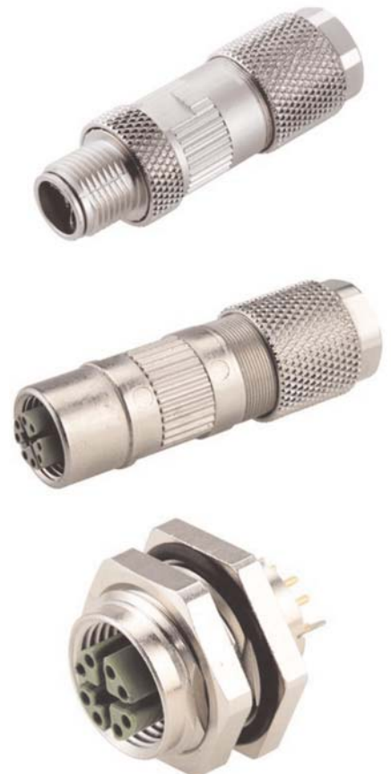
Rys. 6. X-Ethernet 10 Gigabitów – złącza swobodne oraz pulpitowe do Ethernetu przemysłowego Cat. 6A 10 Gbit/s, kodowanie X, do stosowania w trudnych warunkach przemysłowych (IP67)
