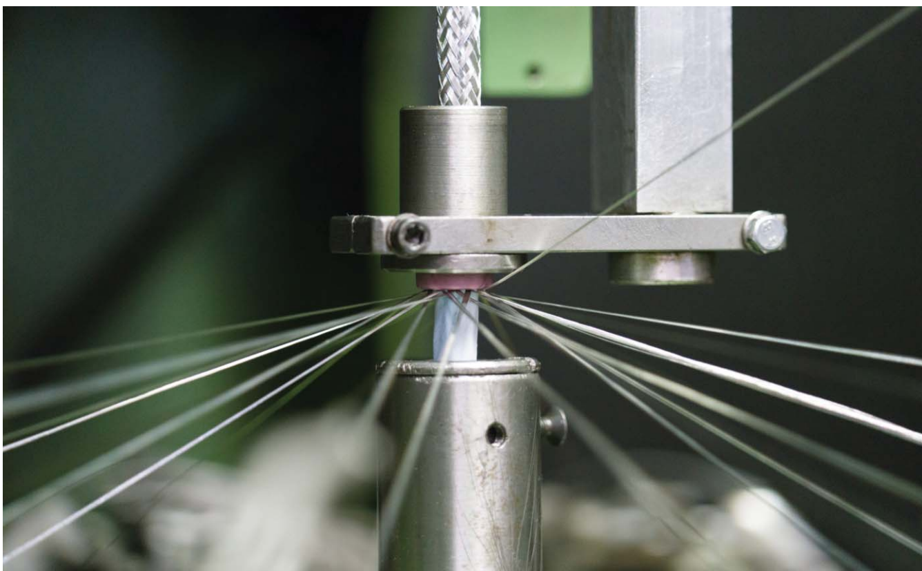
Rys. 4. Podczas ekranowania, cienkie druciki z czystej miedzi lub miedzi cynowanej są oplatanie wokół skręconych par żył – uodparniając przewód na zakłócenia elektromagnetyczne
