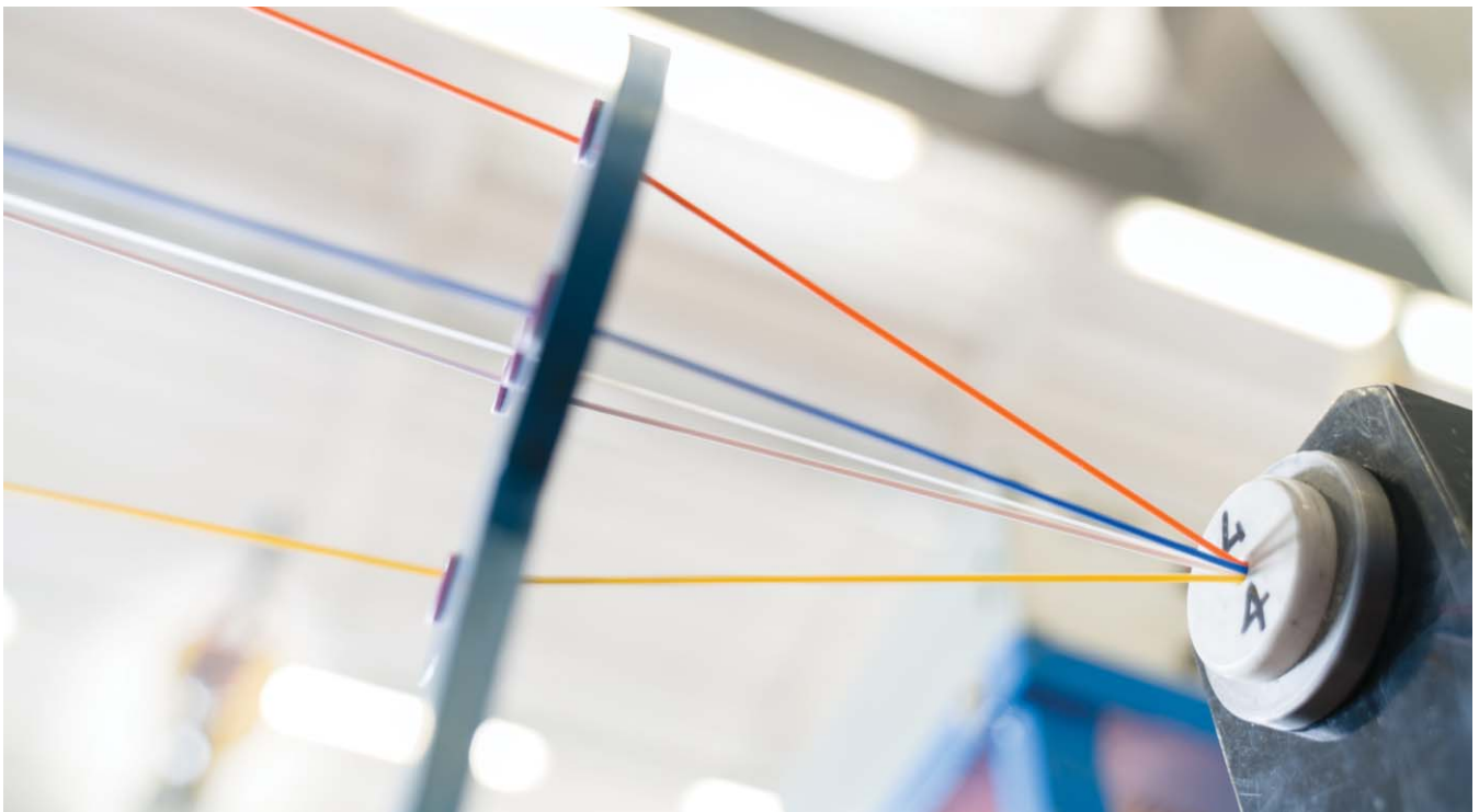
Rys. 3. Technologia skręcania żył w czwórki gwiazdowe przyczynia się do zredukowania średnic zewnętrznych przewodów.
