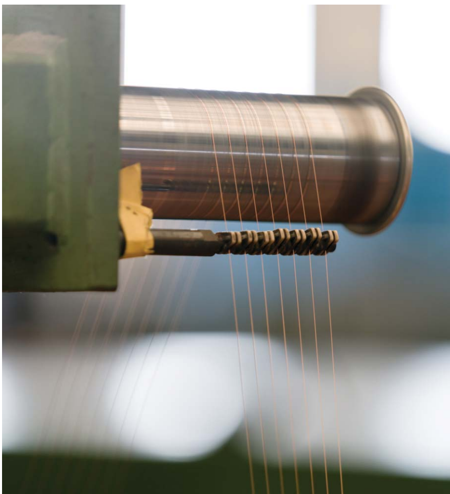
Rys. 1. Żyły przewodów ethernetowych zbudowane są z cienkich miedzianych drucików, odpowiednio skręconych ze sobą w linkę.
