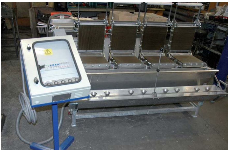
Rys. 1. Gofrownica przemysłowa – widoczne elementy okablowania firmy Lapp Kabel
