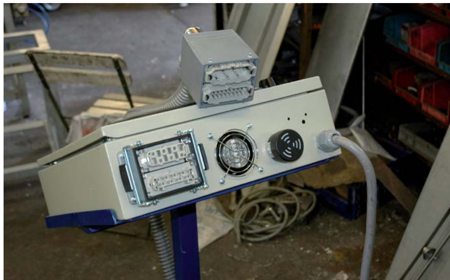
Rys. 6. Złącze Epic – zasilanie i sygnały w jednej obudowie
