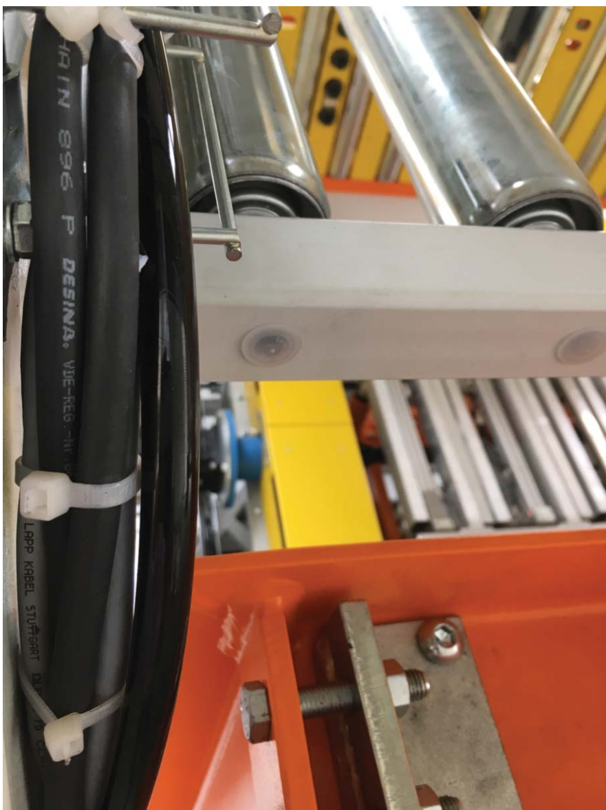
Rys. 3. Ölflex Chain 896 P – wielożyłowy przewód w z płaszczem zewnętrznym z olejoodpornego poliuretanu zastosowany w obrotnicy Intek
