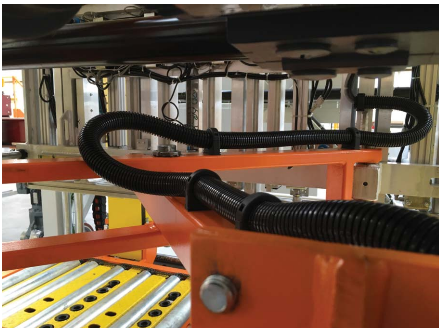
Rys. 4. Silvyn FPAS – giętki i wysoce odporny na ściskanie peszel chroniący oprzewodowanie obrotnicy
