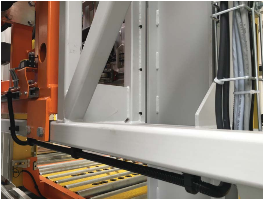
Rys. 2. Obrotnicę wyposażono w przewody Lapp Kabel dedykowane do trudnych warunków pracy związanych z cyklicznym ruchem zginającym
