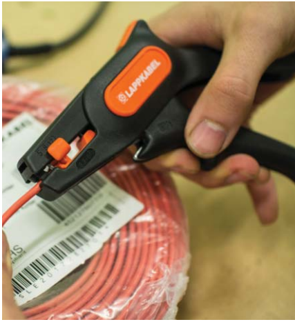
Rys. 3. Narzędzie Lapp Kabel Basic Strip do odizolowywania i cięcia, wykorzystywane podczas prac nad bolidem Cybina
