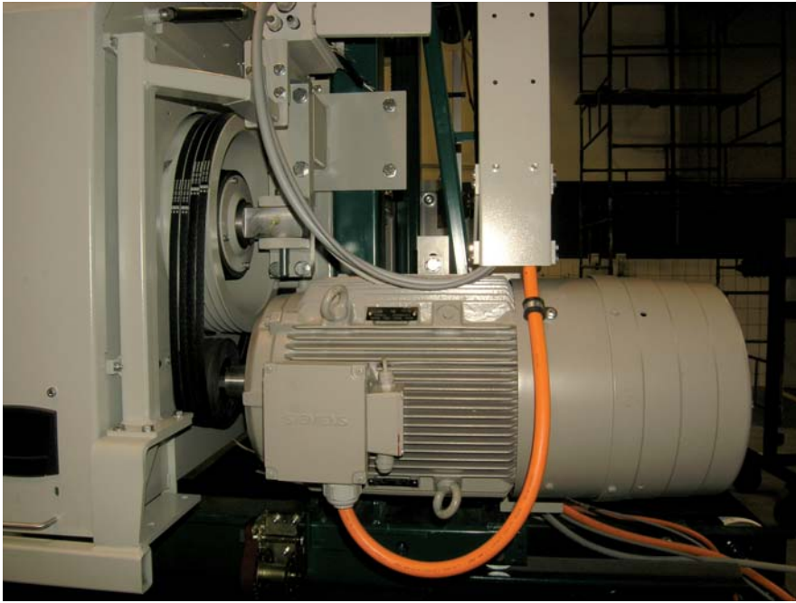
Rys. 3. Zasilanie silnika przewodem Ölflex Servo FD 796 CP
