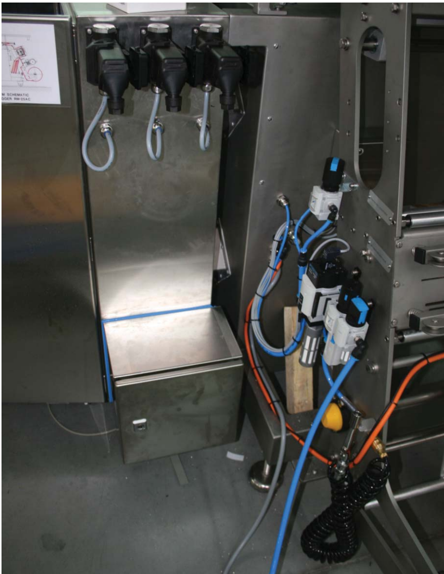
Rys. 2. Maszyna pakująca Radpak w trakcie montażu – widoczne elementy okablowania Lapp Kabel
