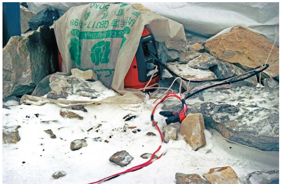
Rys. 3. Podczas polskich wypraw w Himalaje i Karakorum zastosowano przewody Ölflex Heat 205 SC i Ölflex Heat 180 EWKF. Były one używane do okablowania generatora i połączenia głównego oraz przełączania światła w kuchni i namiotach w obozie podstawowym na wysokości 5 100 metrów n.p.m.
