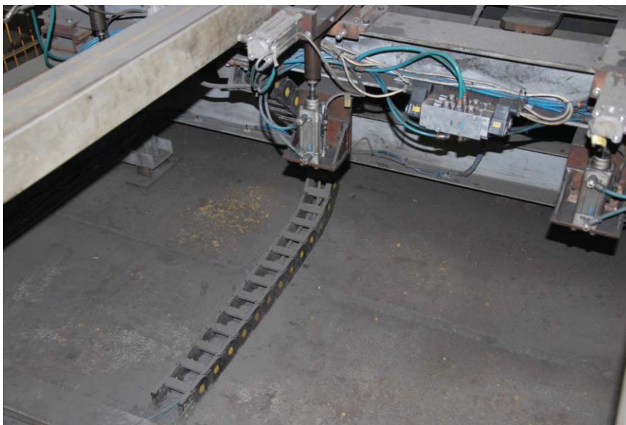
Rys. 9. Prowadnica kablowa Brevetti Stendalto zamontowana w giętarce krat 3D
