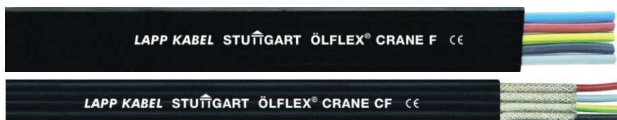
Rys. 12. Przewody płaskie: Ölflex Crane F i jego ekranowany odpowiednik Ölflex Crane CF
