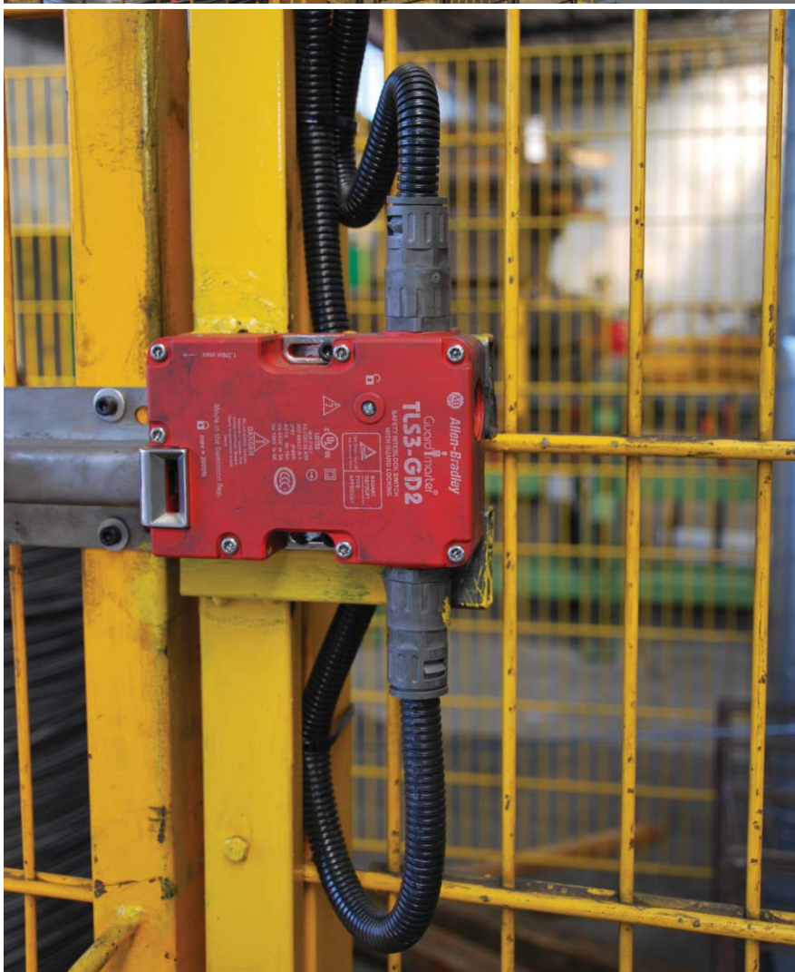
Rys. 5. Ochrona przewodów systemu bezpieczeństwa z wykorzystaniem peszli Silvyn Rill PA 12 oraz złączek Silvyn Klick GPZ produkcji Lapp Kabel
