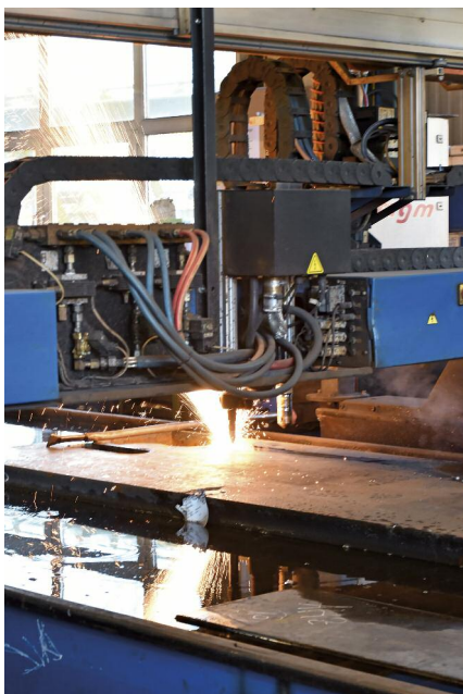
Przecinarka plazmowa przecina stalową płytę o grubości kilku centymetrów
