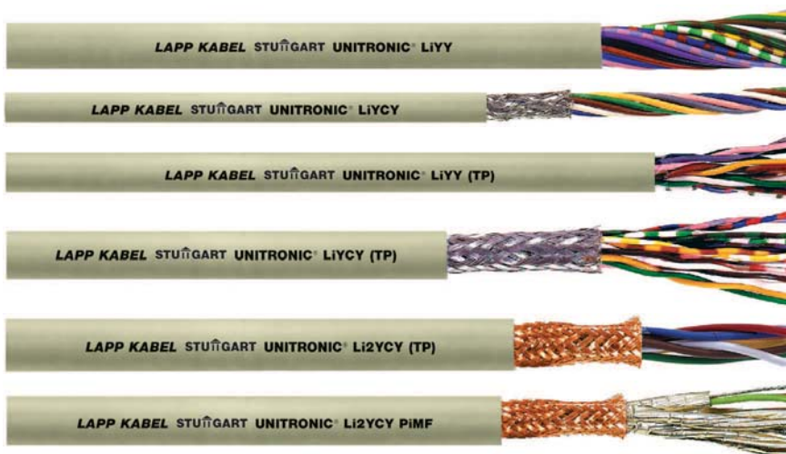
Rys. 7. Przewody z grupy Unitronic – od góry: Unitronic LiYY, Unitronic LiYCY, Unitronic LiYY (TP), Unitronic LiYCY (TP), Unitronic Li2YCY (TP), Unitronic Li2YCY PiMF
